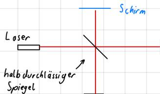
Auf dem Schirm ist ein Bild zu sehen, welches sich bereits für kleine Änderungen in der Zeit, welche die jeweiligen Laserstrahlen benötigen, um zu dem Schirm zu gelangen, ändert. Wenn die gesamte Apparatur gedreht wird, so verändert sich das Bild auf dem Schirm nicht. Daraus folgt, dass die Lichteschwindigkeit in alle Richtungen gleich zu sein scheint.
