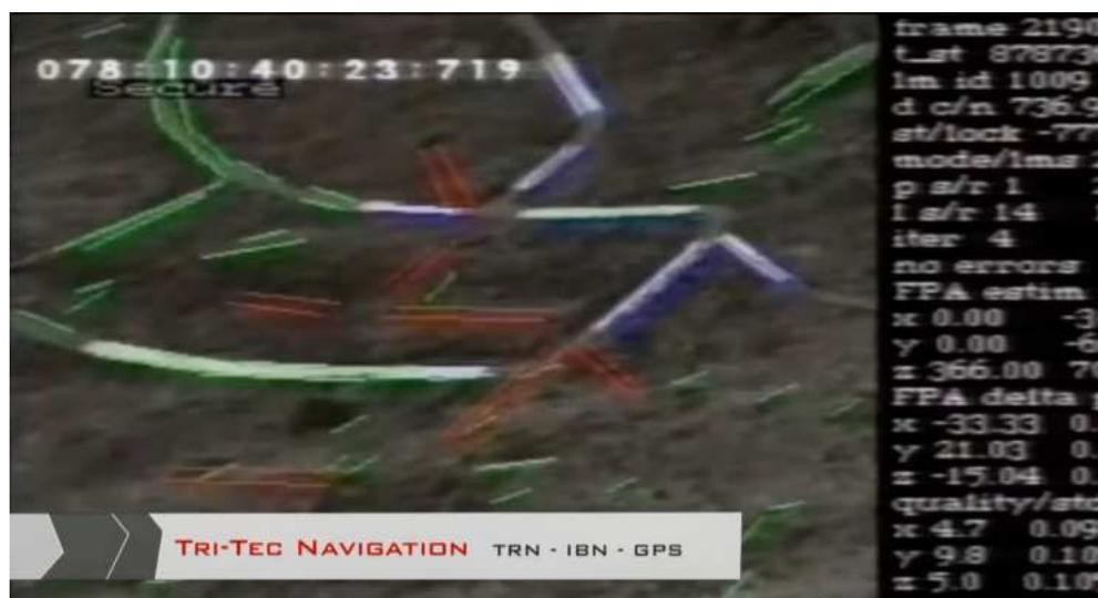
Abbildung 9: Wärmebild eines Referenzgeländeabschnittes im Flug mit erkannten sowie korrelierten Kanten und Telemetrie (MBDA [30]).
