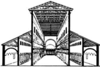
Abb. 2: Querschnitt der fünfschiffigen Konstantinsbasilika.
